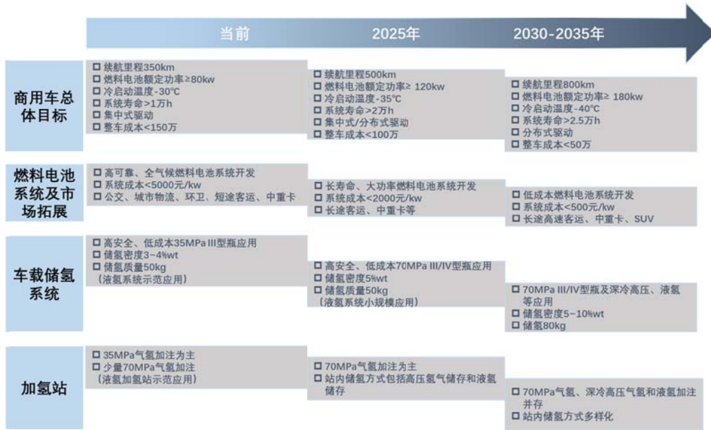
图 8-4 氢能燃料电池商用车技术路线图
