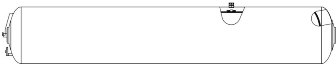
图 7-15 25 m 3 液氢公路槽车储罐示意图
