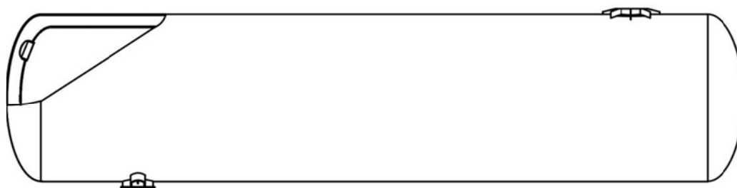
图 7-11 170 m 3 液氢储罐主要结构图
