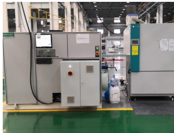
温度循环与压力脉冲试验
