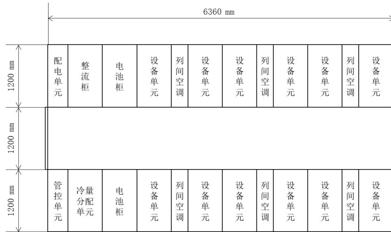
图 5.5 水冷列间空调微模块布局示意图
