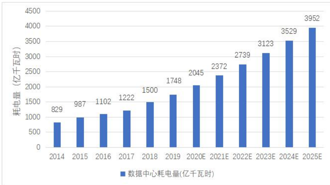
图 1.2-1 2014-2020 年全国数据中心耗电量及预测（图中 E 表示预测值）
