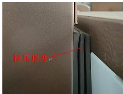
门体顶部挤压形变
