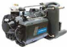
谷轮涡旋™飞迅压缩机整合了喷气增焓组件，可使压缩机在所有工况下保持良好运行性能；压缩机自带CoreSense™诊断模块可更快、更准地监控压缩机运行状态，防止压缩机出现故障；紧凑的半封闭结构设计，实现更小振动和更低噪音，提高系统可靠性。
