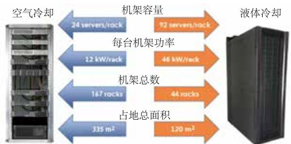
图4 2MW数据中心空气冷却和液体冷却对比
