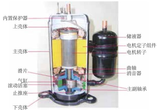
图1 低充灌量R290空调压缩机结构简图
